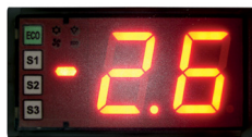
Electronic control with energy saving button and three different temperature range settings / Control electrónico con botón ahorrador de energía, y tres diferentes rangos de temperatura de operación.
